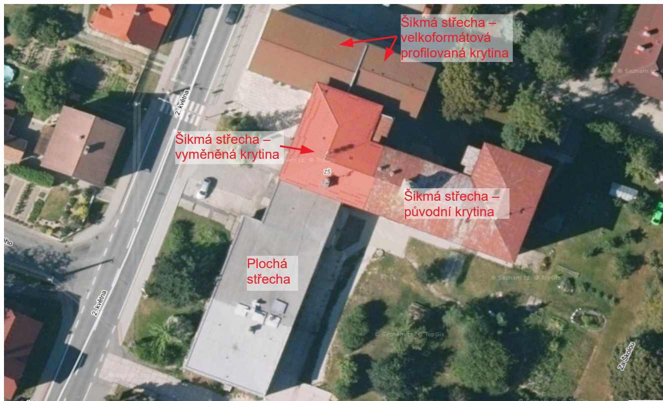
obr. /24/ Schéma zastřešení objektu
